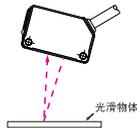
若在传感器下有一个类似镜子的物体，传感器运行可能不稳定。因此，应倾斜传感器或如下图所示使其离开类似镜子的物体。
