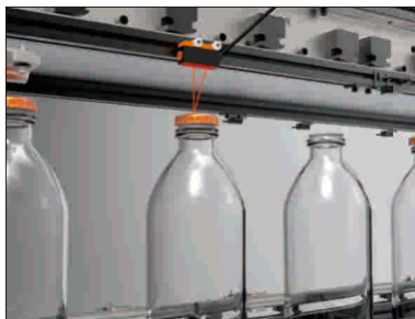
罐装流水线上瓶盖的有无检测
