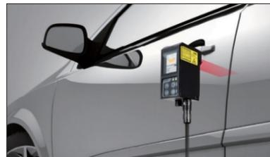
汽车车门间隙, 高度差测量
